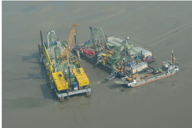
Bohlen & Doyen, Transpooling of cable from CLB „Bodo Installer“ to CLB „Bodo Connector“...
